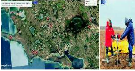
चित्र 2.3.4.1. (क) कैम्ब्रिज बे, नुनावुत प्रांत, कनाडाई उच्च आर्कटिक क्षेत्र का मानचित्र। रेड कॉलआउट नमूनाकरण स्थान दिखाते हैं, (ख) पर्माफ्रॉस्ट कोर नमूनों की ड्रिलिंग।
