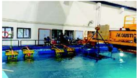
चित्र 3.1.1.ई. : PDE, IDE, थ्रस्टर्स, कैमरा और लाइट के साथ इंटीग्रेटेड टेस्टिंग
