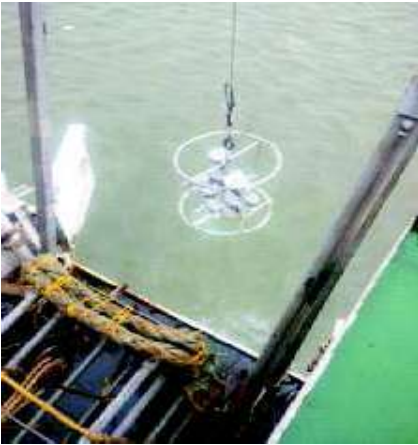
चित्र 3.3.4.बी. : FORV सागर संपदा पर ड्रॉप कैमरा प्रणाली की तैनाती
