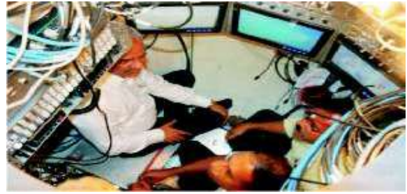
चित्र 3.1.1.सी. : गोलाकार पेंदी के अंदर नियंत्रण प्रणाली के साथ HSSS
