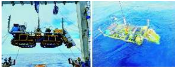
चित्र 3.1.2.एच. : तथा 7.1.2.आई . वराह-3 समुद्रतल खनन मशीन की तैनाती
